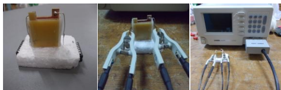
Gambar 4 Proses penentuan karakter dielektrik udara dengan LCR-Meter
