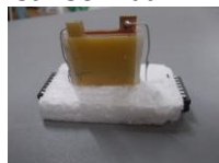
Gambar 1. Plat kapasitor untuk mengukur dielektrik minyak
